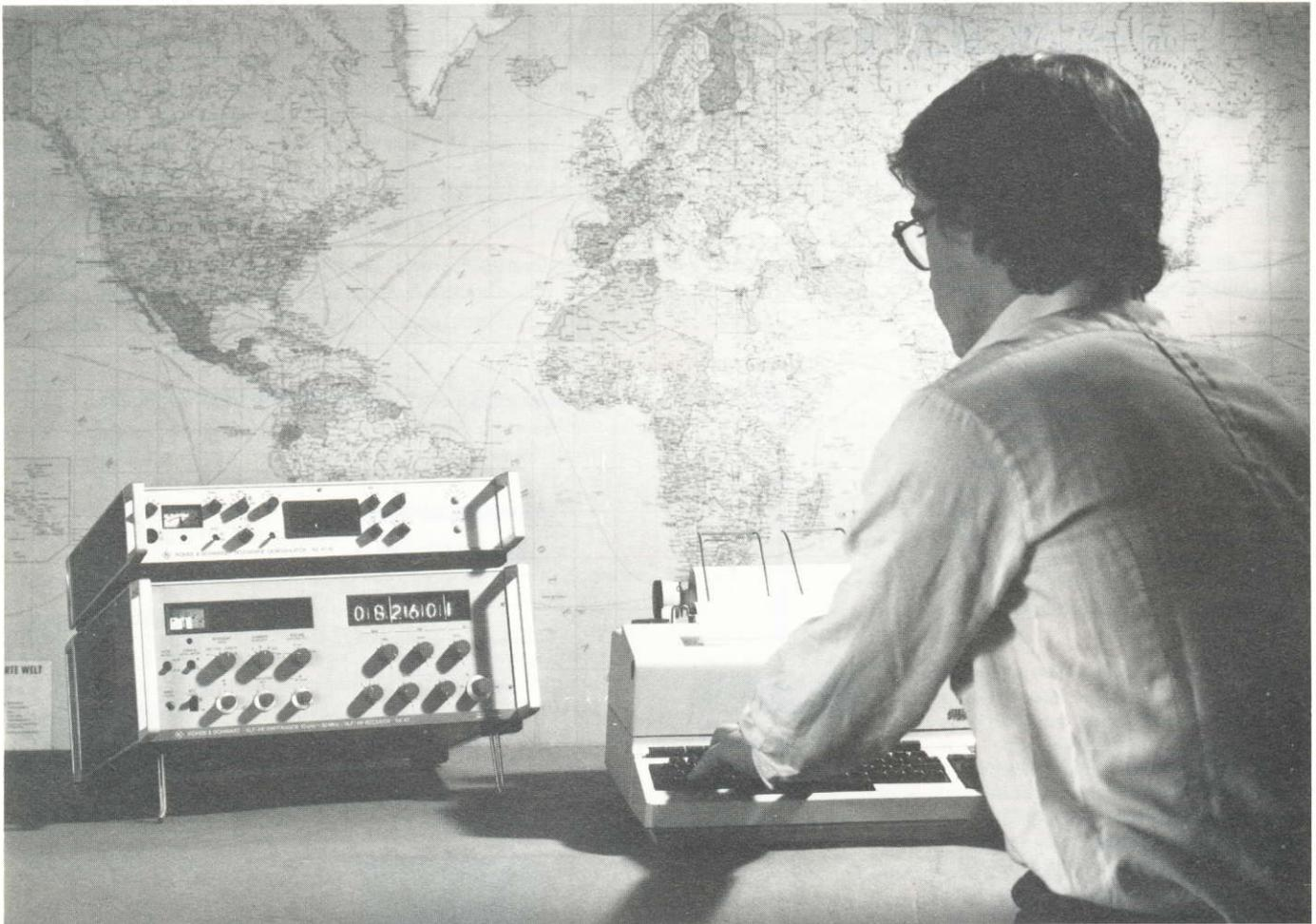
BILD 1 Kleine Fernschreib-Empfangsstation mit Funk-Betriebsempfänger EK 47, Telegrafie-Demodulator NZ 47/10 und Siemens-Fernschreiber 1000. Foto 28 200
